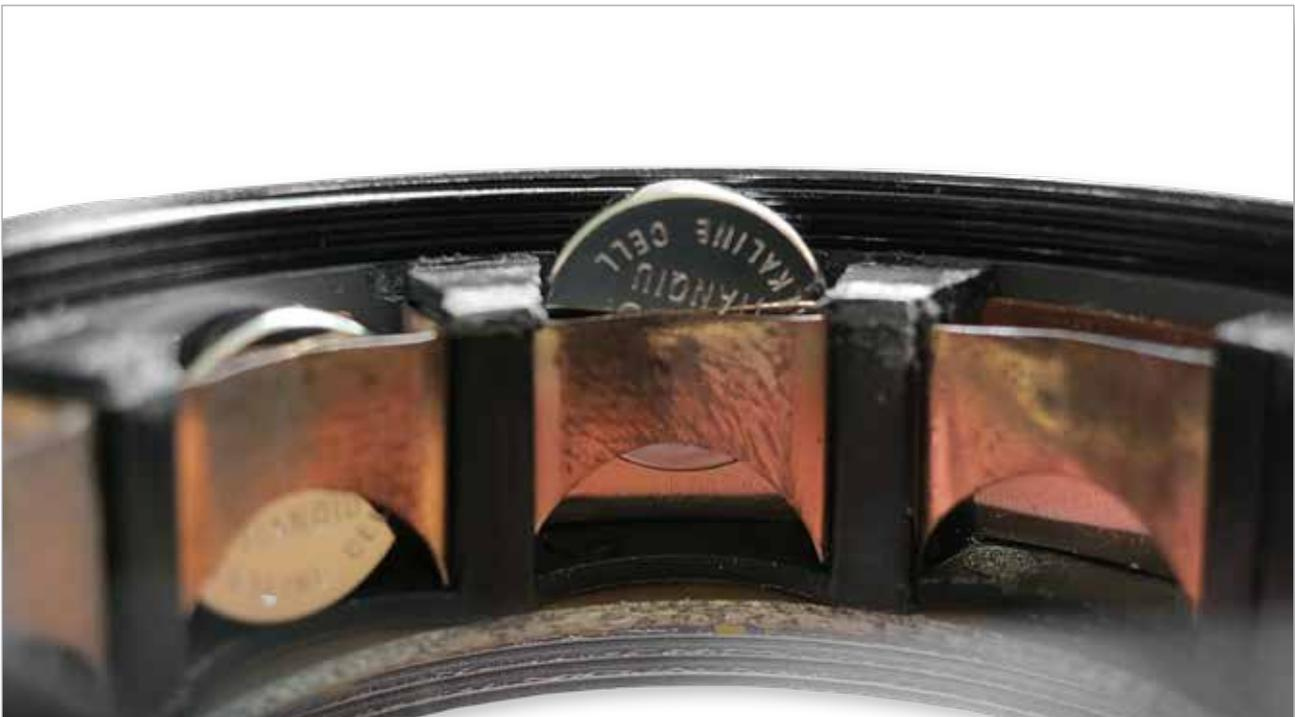
Nun die neuen Batterien vorsichtig von oben in die Haltetaschen einschieben. Alle Teile wieder zusammenbauen und der Batteriewechsel ist fertig.
